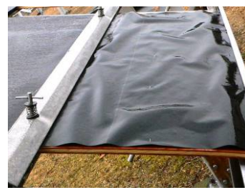
写真8 8kg品の屋外暴露6日後の状態
